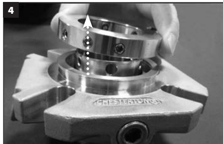
Wyjąć pierścien zaciskowy z rękawa i odłożyć.
