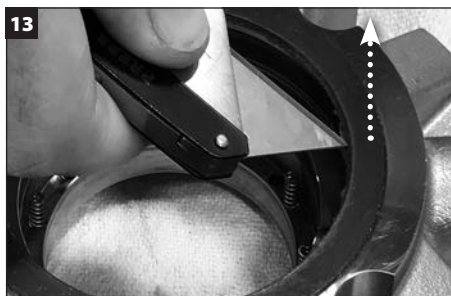
Wyjąć uszczelkę komory dławnicowej z dławika i wyrzucić.
