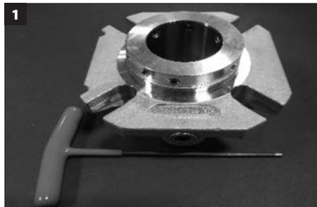
Narzędzia potrzebne do demontażu uszczelki: klucz sztorcowy (dostarczony z uszczelką), szczypczyki (pinceta) i zakrzywione ostrze (dostarczone przez klienta - do usunięcia O-ringów i tunelu napędu).
