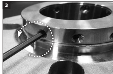
Wyjąć z pierścienia zaciskowego wszystkie wkręty dociskowe z końcem wgłębionym i 1/4 z czopkiem i wyrzucić.
